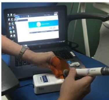
Figura 1 Dispositivo checkMARC portátil conectado a la computadora Fuente: Imagen propia
